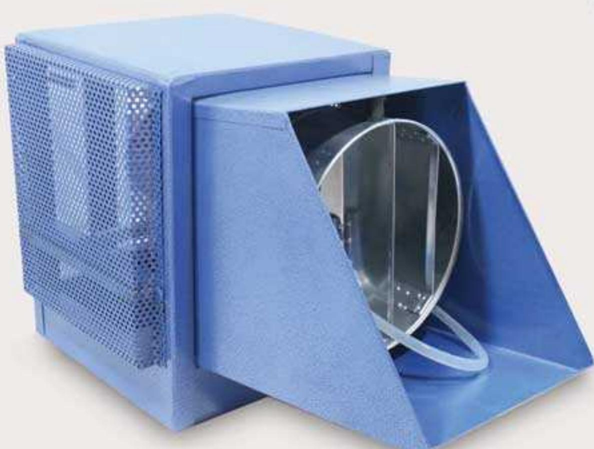
این دستگاه بعد از اتصال به برق شروع کار می کند و در ابتدای کار آب از داخل باک به درون دستگاه کشیده می شود و صفحه دیسک را به حرکت در می آورد. در گام بعدی صفحه دیسک با دوران سریع خود آب را به رطوبت تبدیل می کند و در آخرین مرحله رطوبت تشكیل شده توسط پروانه دستگاه به محیط منتقل می شود. حائز اهمیت است بدانید که در مه پاش ۱۰۰۰۰ دکتر قشلاق جهت جلوگیری از پاشیده شدن غیر مستقیم آب از فشارشکن گردید یک بهره گیری شده است.
