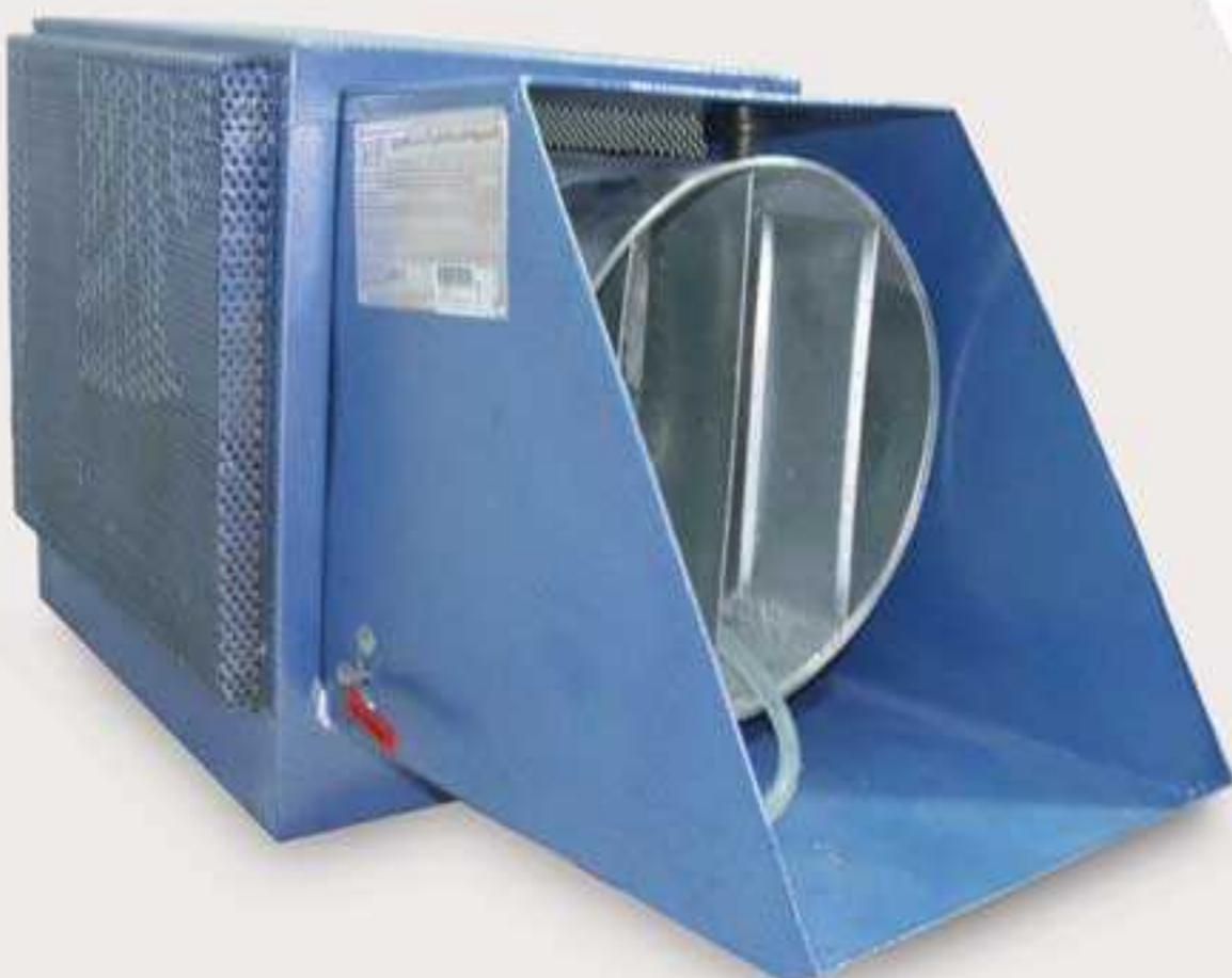
نحوه کارکرد این دستگاه به گونه ای است که ابتدا آب موجود در باک از طریق پمپ دمنده وارد دستگاه شده و سپس با استفاده از لوله های آلومینیومی موجود در دستگاه به پشت پروانه انتقال می یابد . در بخش پشتی پروانه یک دیسک و حلزونی وجود دارد که به پروانه آلومینیومی الحق شده است و در هر ۱ ثانیه بالغ بر ۵۰ چرخش انجام می دهد . هنگامی که آب داخل دستگاه با کمک پمپ به این پروانه پاشیده می شود به دلیل چرخش فوق العاده سریع پروانه آب شکل فیزیکی خود را از دست داده و به بخار سرد تبدیل می شود .
